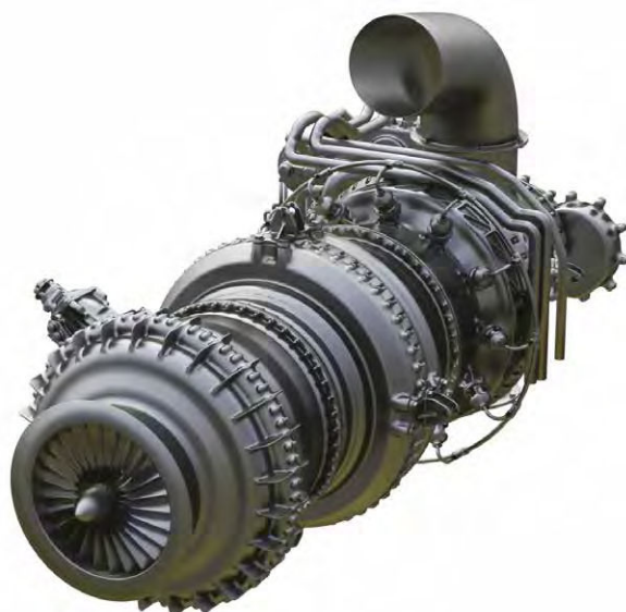
1. Esempio. Turbina a Gas
